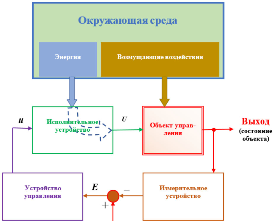
Рис. 2. Структура системы автоматического управления: E – сигнал рассогласования (расстройка или невязка); u – сигнал управления; U – управляющее (энергетическое) воздействие
