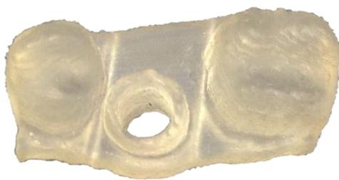
Рисунок 5 – Образец стоматологического шаблона, изготовленный методом быстрого прототипирования
