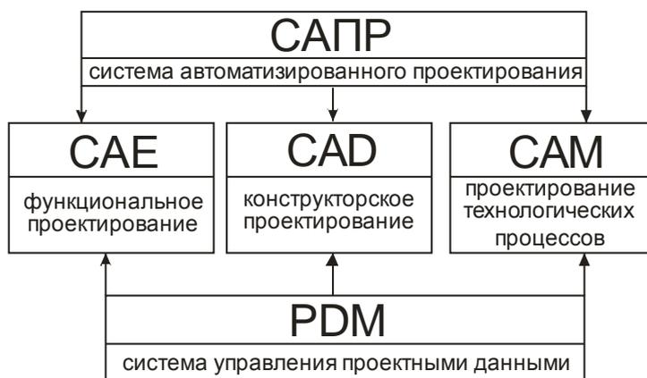
Рисунок 2 – Блок-схема системы автоматизированного проектирования.
