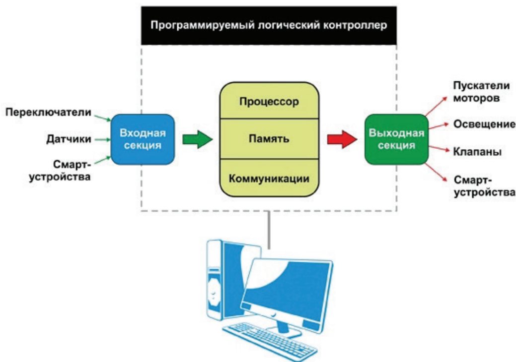
Рис. 1. Упрощённая архитектура программируемого логического контроллера
