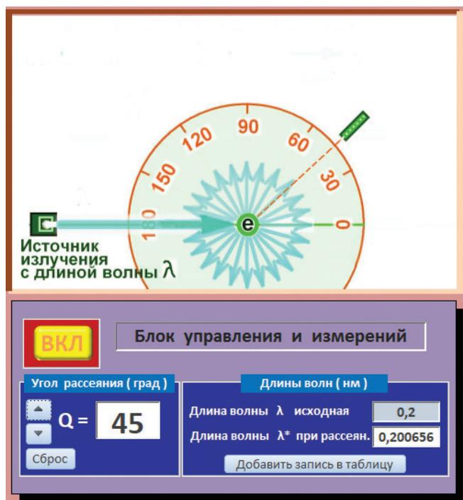
Рис. 3. Установка для исследования эффекта Комптона
