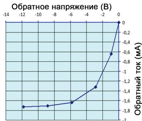
**Зависимость I(U) открытого диода**
